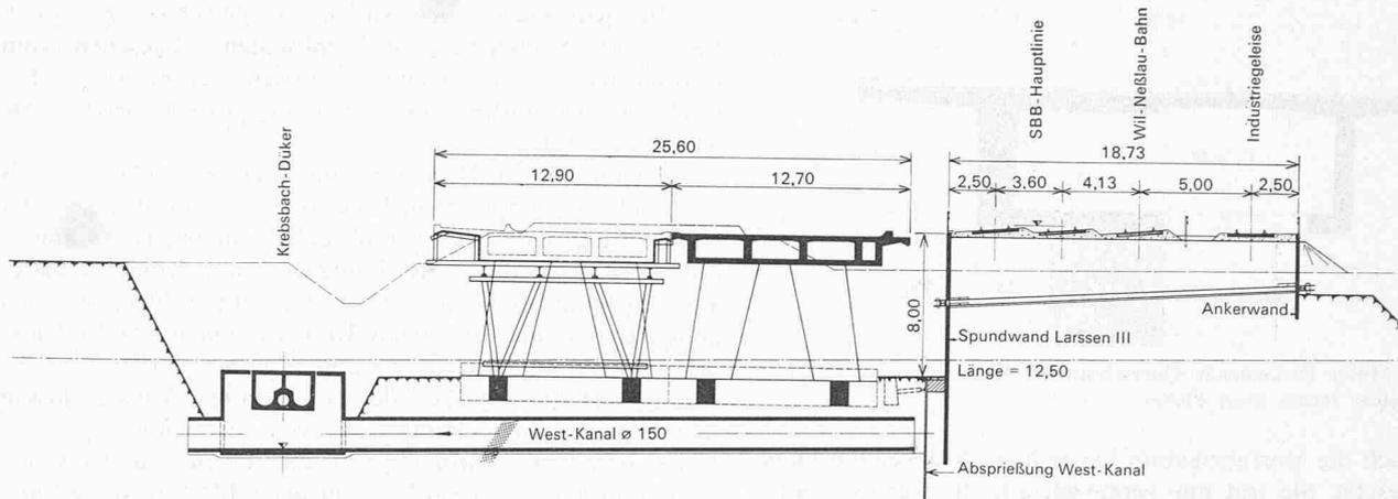
Überführung der SBB über die Autobahn in Wil, Querschnitt Ost—West 1:450 im Bauzustand; rechts die provisorisch umgelegten Gleise (Baustellen-Umfahrung)
