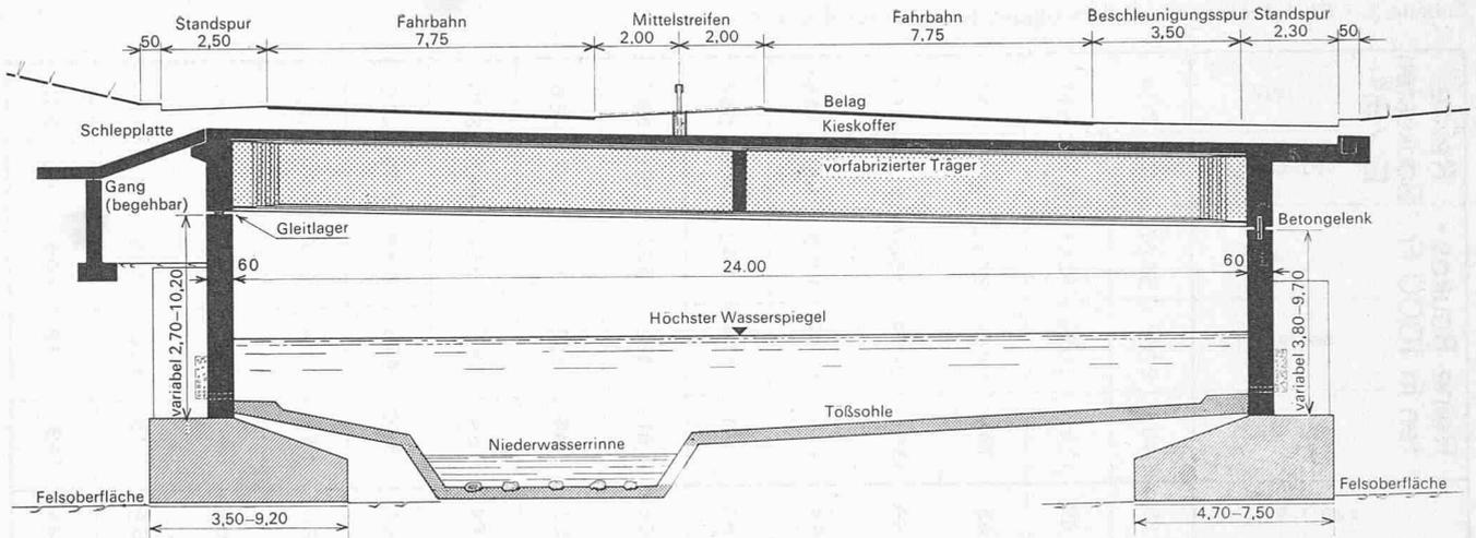
Tössüberdeckung in Winterthur. Querschnitt 1:200 durch das Bauwerk
